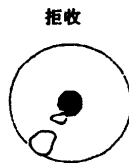
图 2071-3 超过玻璃密封区 1/3 的气泡
